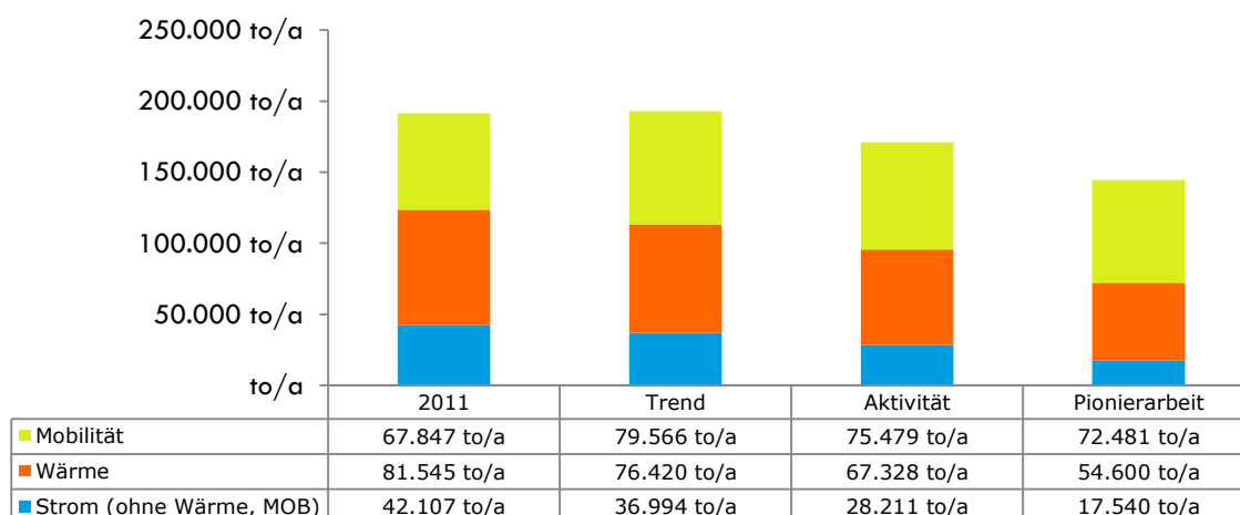
Abbildung 41: Entwicklung der CO 2 -Emissionen bei verschiedenen Szenarien für die Bereiche Strom, Wärme und Mobilität [Mio. t/a].
