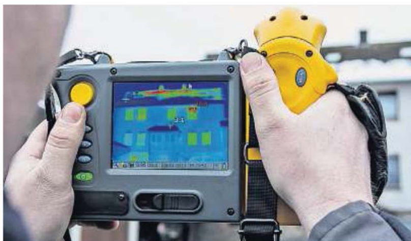
Wenn es im Dach – oder sonst wo – rot leuchtet, dann gibt das Haus mehr Wärme ab, als es sollte. Eine Sanierung lohnt sich in diesem Fall, betonen Bürgermeister und Erster Stadtrat. Archivfoto: gl
